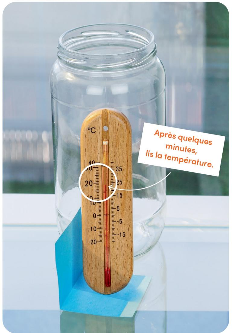
**3** Enfin, installe le thermomètre contre le bocal et pose sur l'un des rabats de la feuille, l'autre reste levé. Le bas du thermomètre est ainsi à l'ombre.
