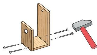
2. Assemble les trois parties (face, base et dos) avec des clous et un marteau.
