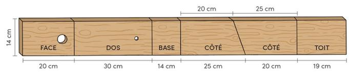
1. Trace les dimensions sur la planche comme sur le schéma. Demande à un adulte de découper les 6 morceaux du nichoir à l'aide d'une scie, et de faire un trou de 33 millimètres avec une perceuse.
